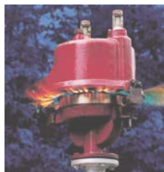
Bild 3a: Dauerbrand-Standzeitversuch mit Membranventil PROTEGO® UB/SF mit dynamischer Flammendurchschlagsicherheit
