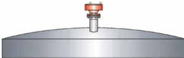
Bild 1: Freie Ent- und Belüftung des Lagertanks mit PROTEGO® EH/0S
