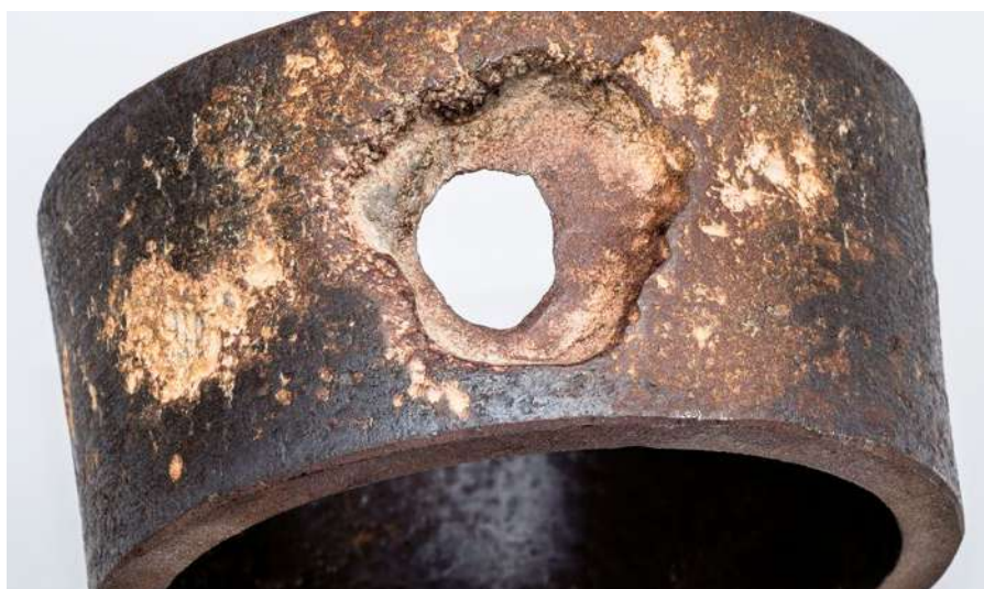
Beispiel von Korrosionsschäden: Lochfrass durch Elektrokorrosion
