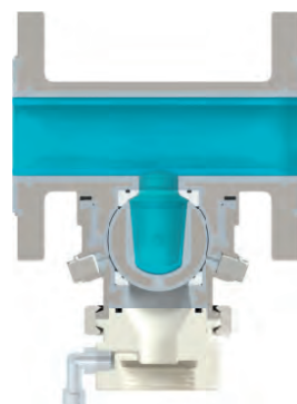
SSB Flansch 1.4408-PFA mit vertikalem Adapter und pneum. Antrieb
